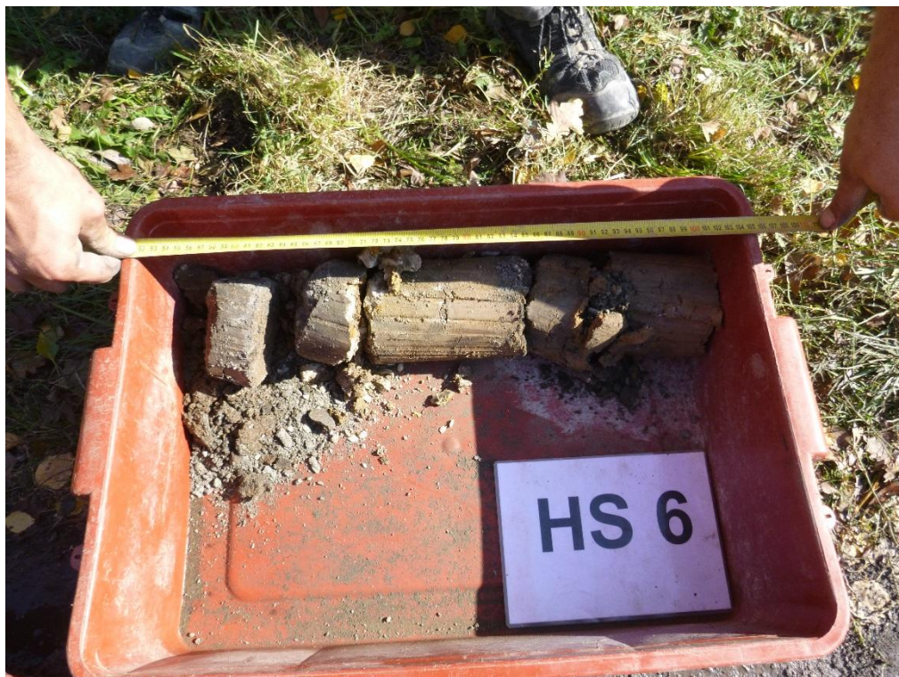
Obr. 13 Vzorkovnice 2/3 vrtu HS6, most 305-019 Štěpánov u Skutče
