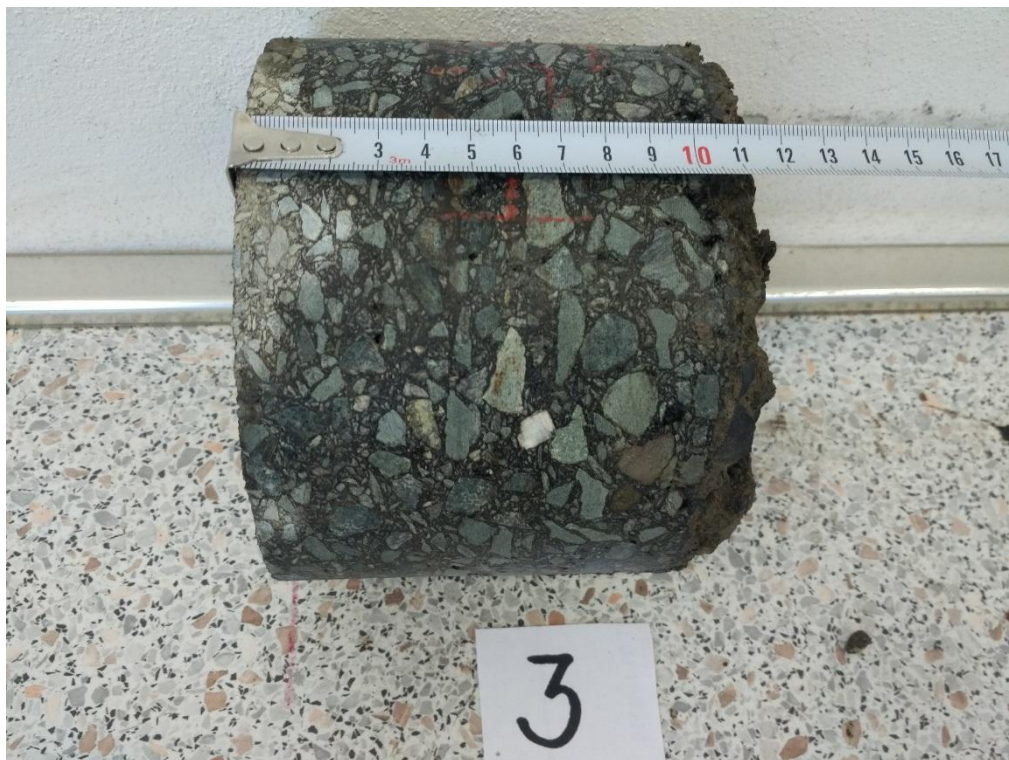
Obr. 21 AC vývrt JV3, most 357-009A Nové Hrady
