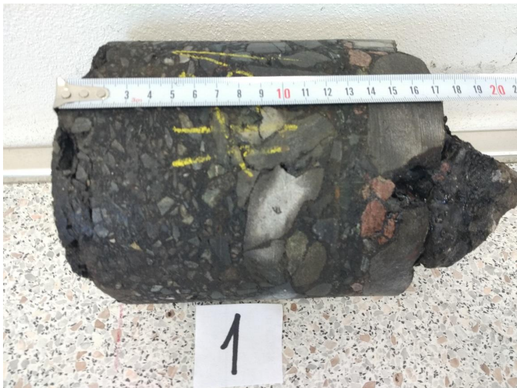
Obr.19 AC vývrt JV1, most 358-015 Litomyšl
