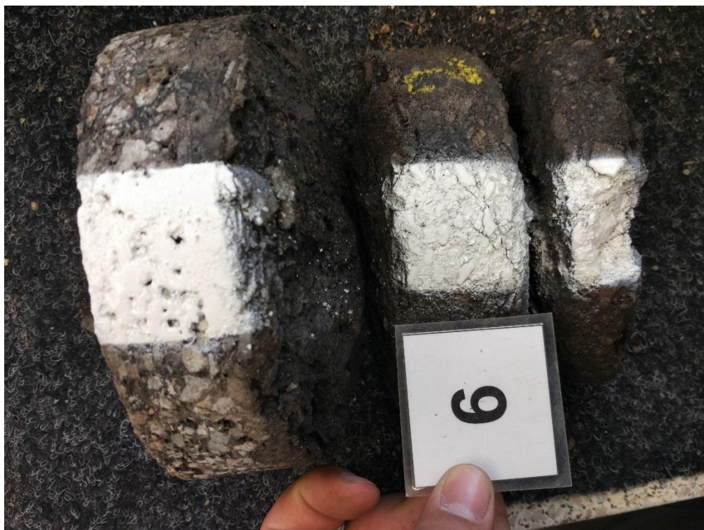
Obr. 32 Detail negativní přítomnosti PAU na AC vývrtnu JV6
