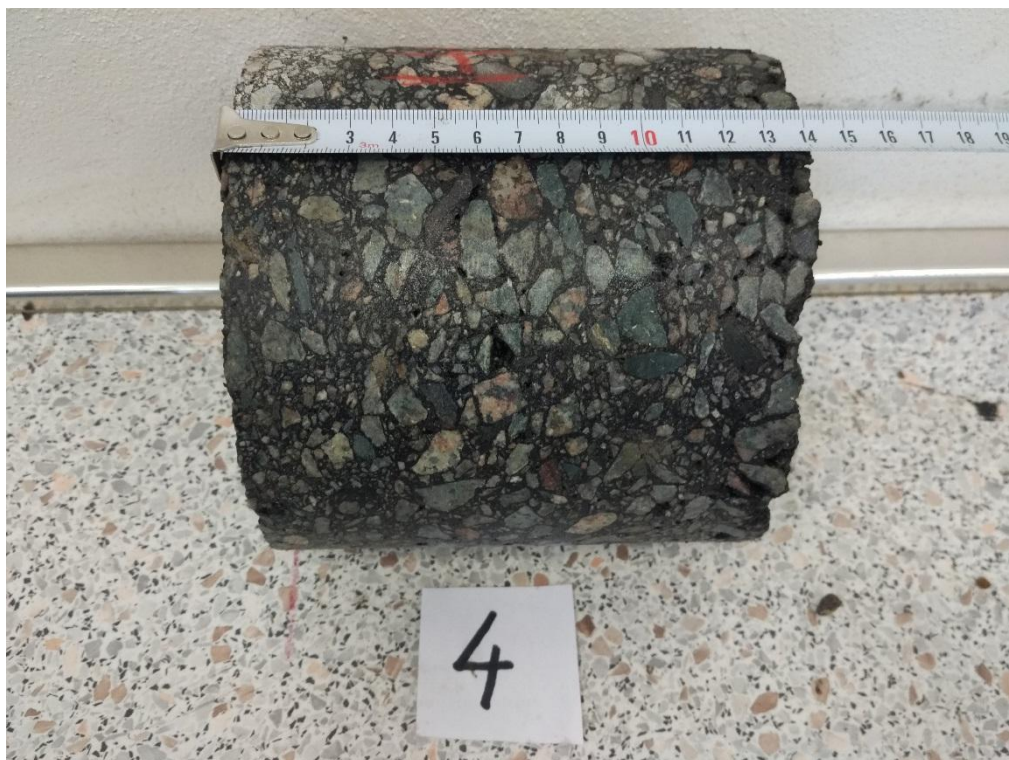
Obr. 22 AC vývrt JV4, most 357-010 Nové Hrady II
