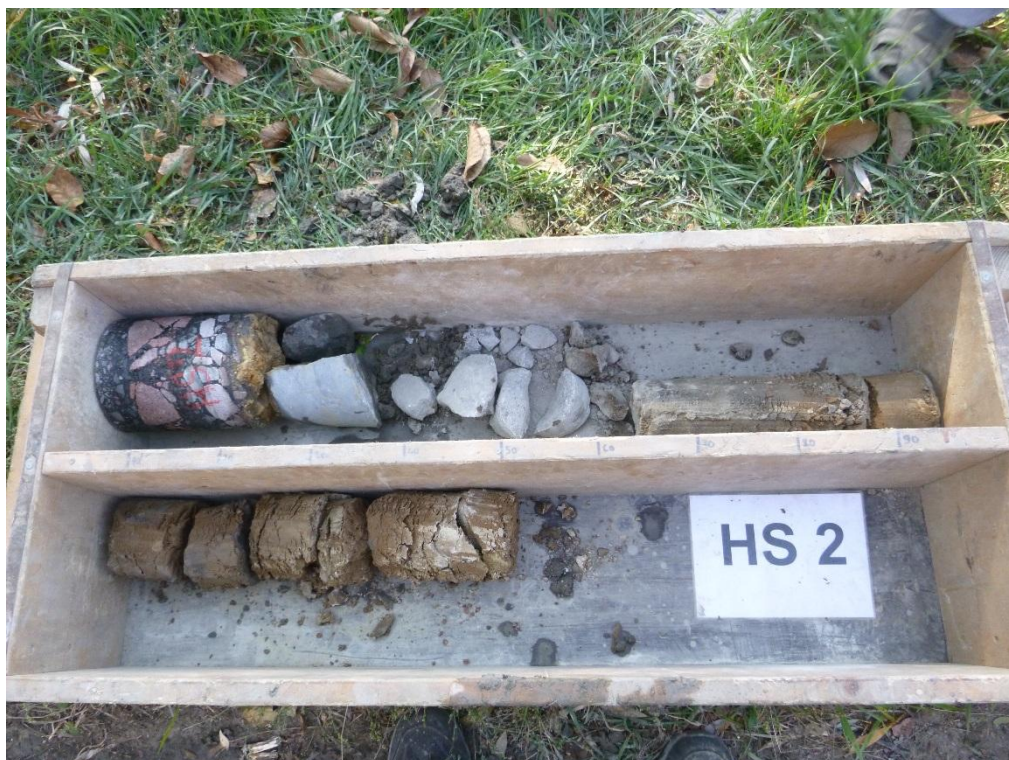
Obr. 4 Vzorkovnice HS2, most 358-014 Višňáry
