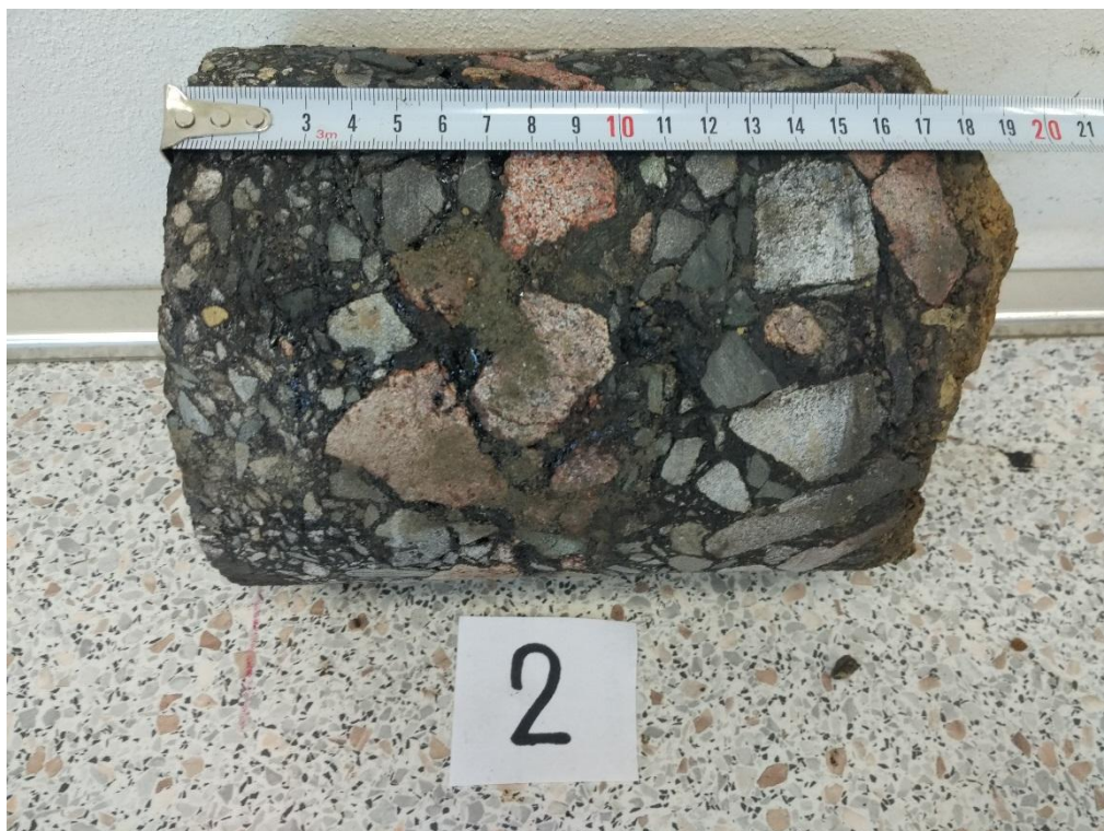
Obr. 20 AC vývrt JV2, most 358-014 Višňový
