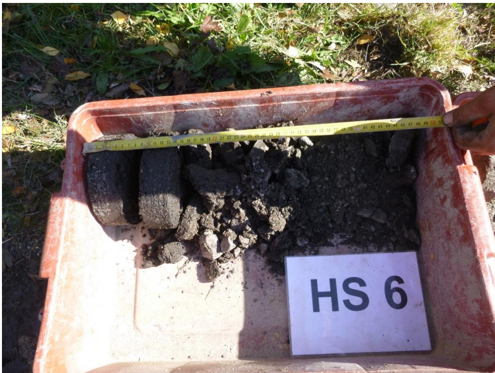
Obr. 12 Vzorkovnice 1/3 vrtu HS6, most 305-019 Štěpánov u Skutče
