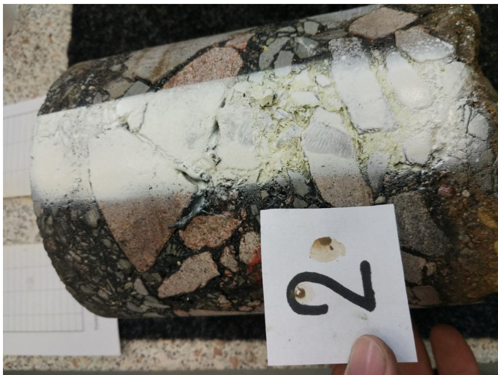
Obr. 28 Detail přítomnosti PAU na AC vývrtnu JV2
