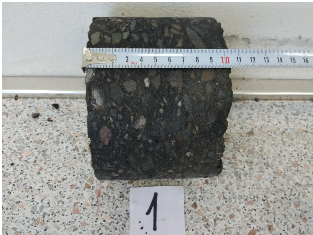
Obr. 25 AC vývrt JV7, most 644-002 Pěčíkov
