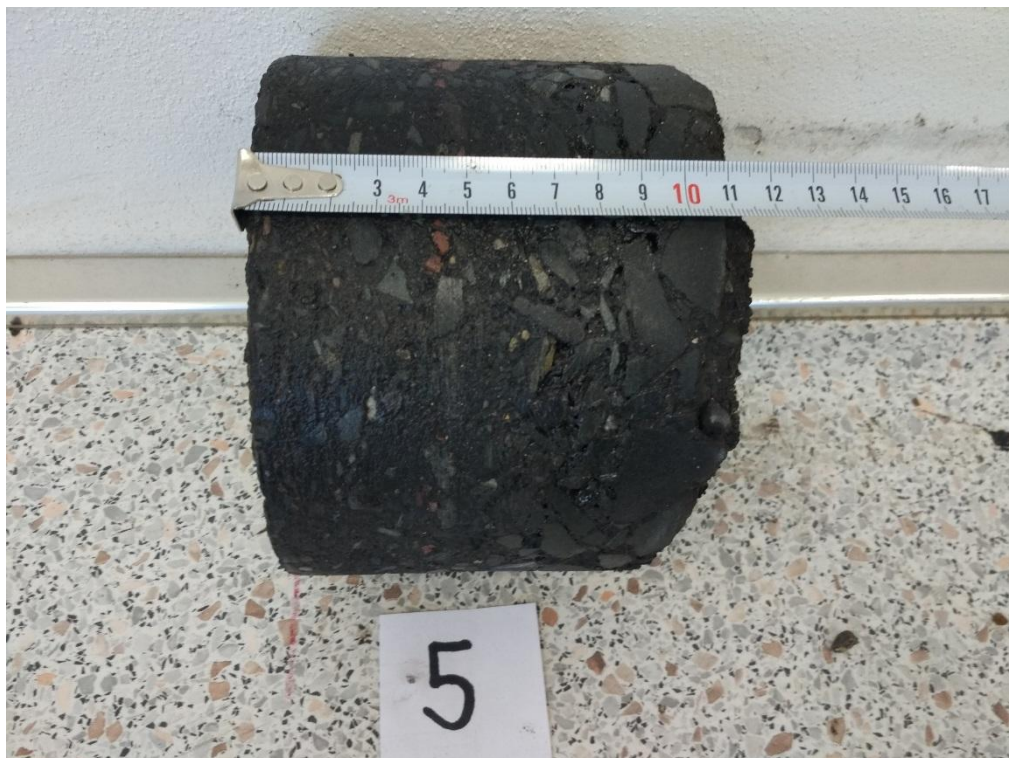
Obr. 23 AC vývrt JV5, most 358-010 Polanka
